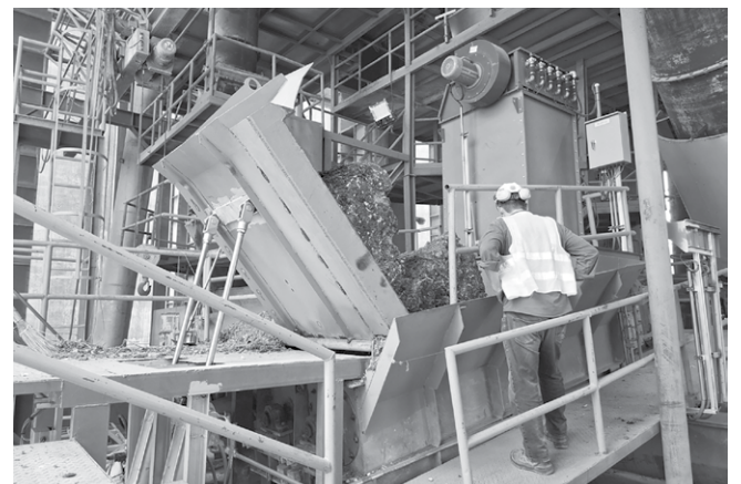
รูป: ระบบการป้อนเชื้อเพลิงชีวมวล ในเตาเผาที่ 6
